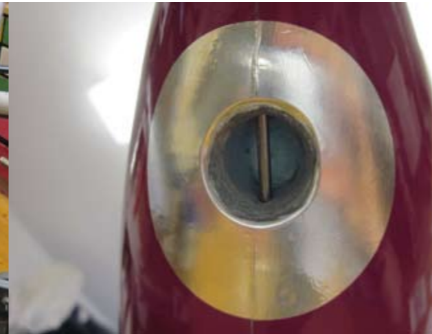
Schleppkupplung aus 3-Millimeter-Stahl Draht von unten betrachtet
