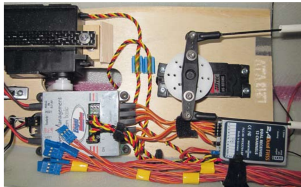
Einbau von Schleppkupplungsservo, Weiche, Empfänger und Vario
