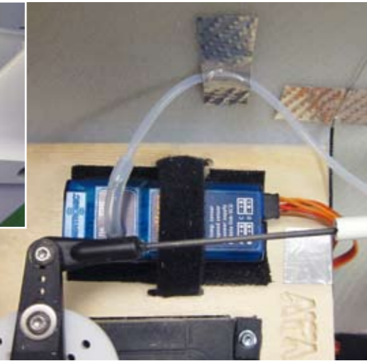
Die TEK-Düse des Weatronic-Varios. Sie wird nach dem Aufbau des Seglers am Platz nur aufgeschoben
