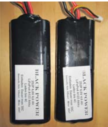
Die beiden 4.000er-LiFe-Akkus für die Bordstromversorgung sind perfekt, um den Schwerpunkt einzustellen
