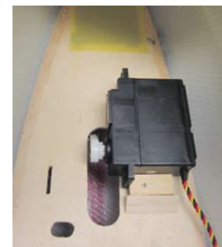
Hier wird das Schleppkupplungsservo positioniert, damit die Unterflurkupplung sicher und auf kurzem Weg angelenkt werden kann
