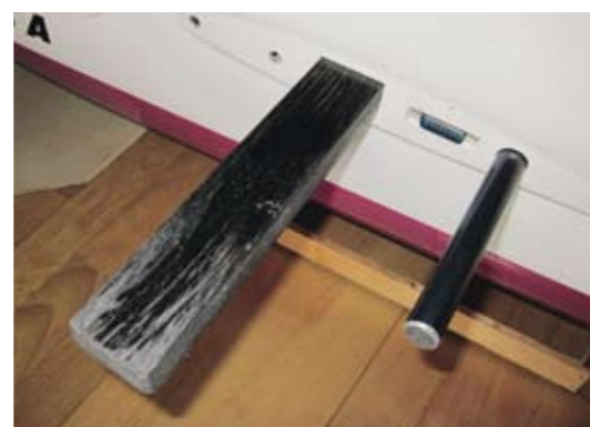
Die beiden Steckungsrohre, vorne CKF und hinten Aluminium
