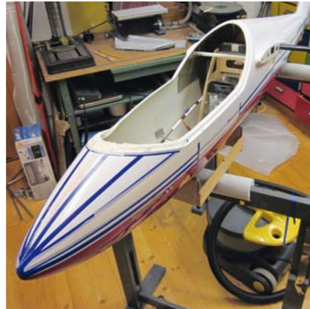
Das Abkleben der zu lackierenden Streifen erfordert Sorgfalt, um ein erstklassiges Ergebnis zu erzielen. Verwendet wurde 3M-Tape
