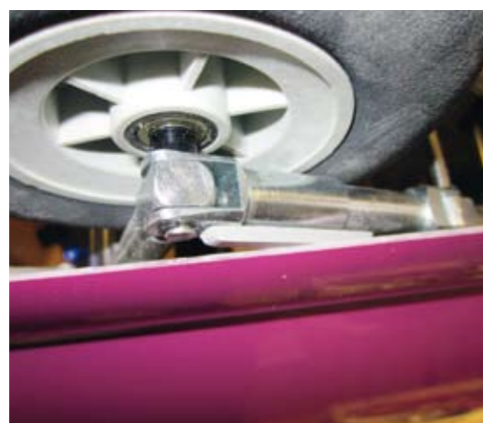
Diese beiden Kunststoffleisten verhindern, dass die Fahrwerksdeckel beim Einfahren am Fahrwerk hängen bleiben
