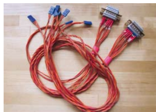
Fertig verlöteter Kabelbaum für die Flügel von bis zu vier Servos
