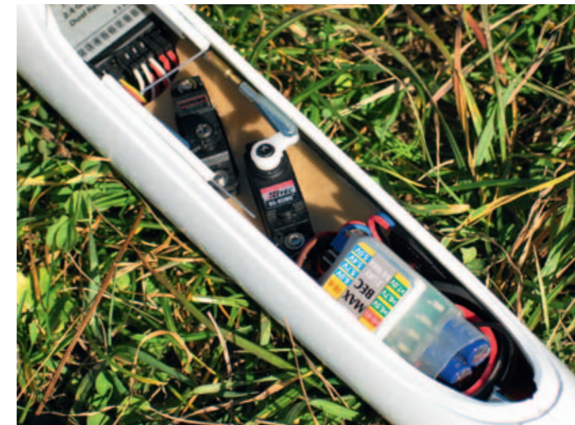
Im Rumpf der Seglerversion ist genügend Platz für alle RC-Komponenten vorhanden
