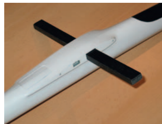
Der Flächenverbinder kann gegebenenfalls als Ballastkammer verwendet werden
